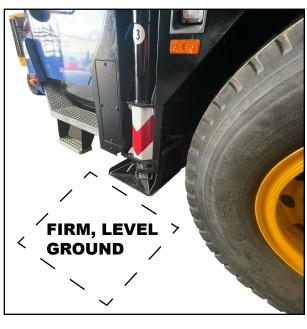
STEP 2 TO BE USED ON FIRM, LEVEL **GROUND.**
